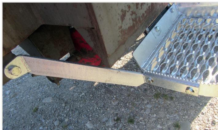
Verstrebung wird mit Sechskantschraube 14 x 30 am Schlepper und 2 Sechskantschrauben 10 x 25 am Auftritt verschraubt.
