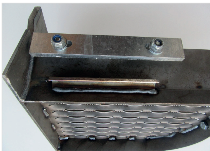
Gegenhalter und Rundung zur Befestigung des Auftritts am Rundeisen des bestehenden Auftritts.
