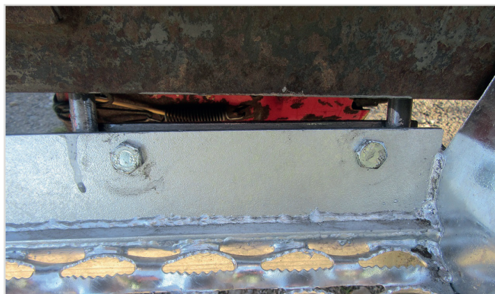
Auftritt wird mit 2 Schrauben 10 x50 am bestehenden Auftritt (Rundeisen) mit Gegenhalter verschraubt.
