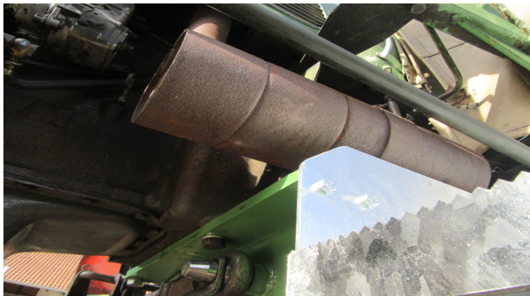
Konsole für Mähwerk u. Auftritt mit 2 Schr. 16x40 mit Sprengring 16,5 am Getriebeblock verschraubt
