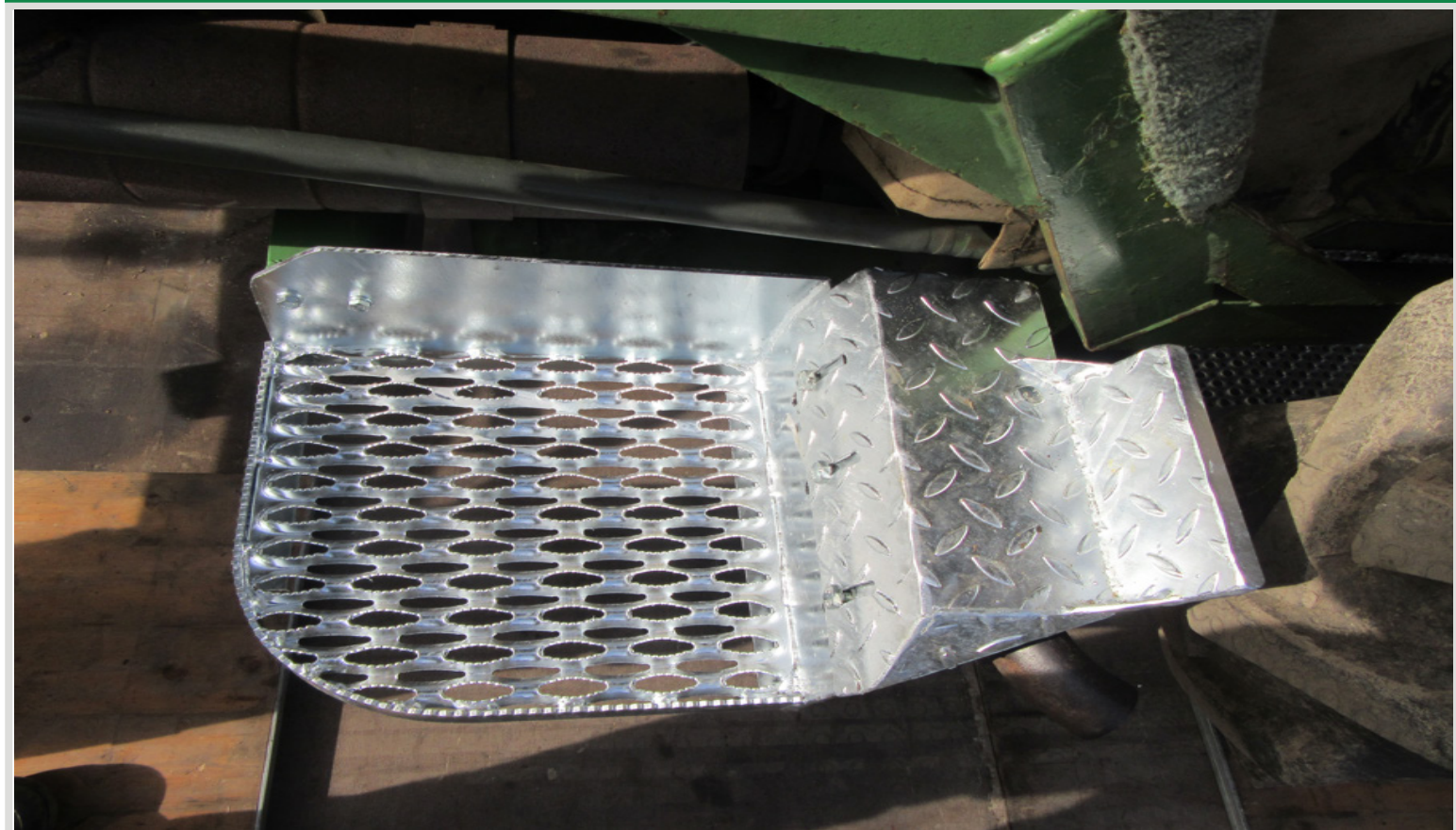
Schutzblech mit Auftritt u. Z-Winkel mit 4 Schrauben 10x25 und Beilagscheiben 10,5x25 verschrauben
