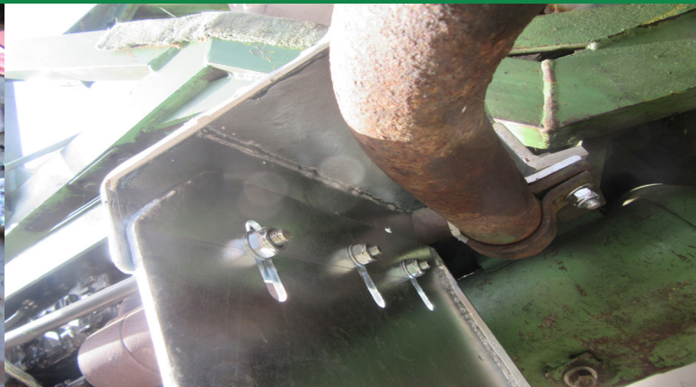
Schutzblech mit Auftritt u. Z-Winkel mit 4 Schrauben 10x25 und Beilagscheiben 10,5x25 verschrauben
