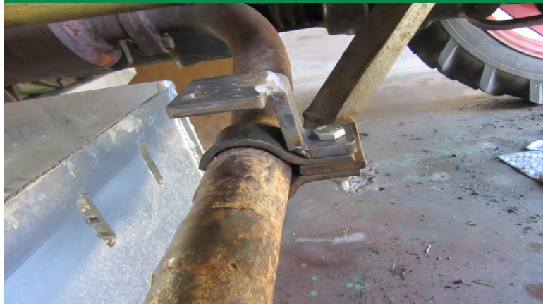
Auspuffschele wird mit Z-Winkel am Auspuffrohr mit Schraube 10x50 verschraubt
