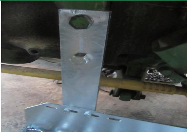
Tritthalter wird mit 2 Schrauben 1 ¼ Zoll mit Federring am Getriebeblock verschraubt
