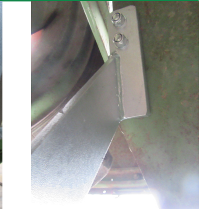
Auftritt wird mit Strebung und 4 Schrauben 8 x 25 am Schlepper abgestützt
