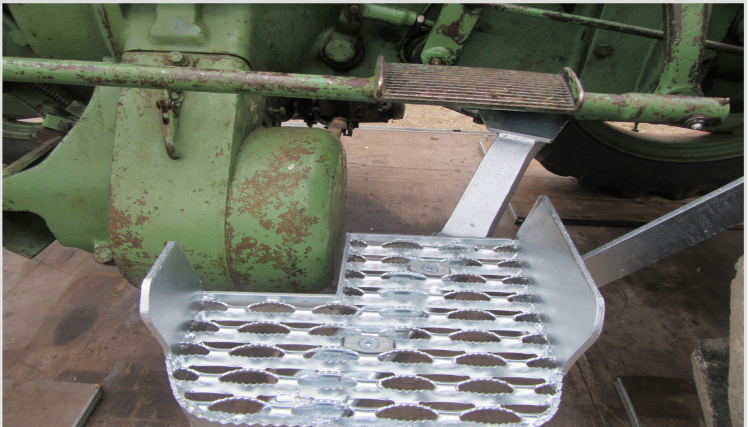
Auftritt wird mit Strebung und 4 Schrauben 8 x 25 am Schlepper abgestützt
