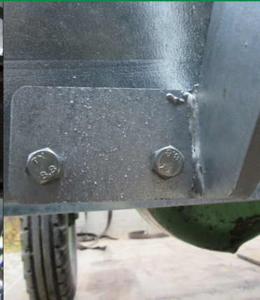
Auftritt wird mit Strebung und 4 Schrauben 8 x 25 am Schlepper abgestützt
