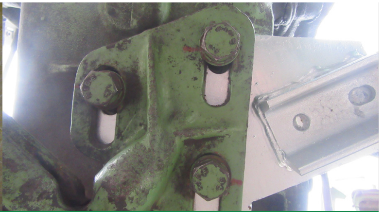
Tritthalter wird mit 3 Schrauben 16 x 45 mit Sprengring 16,5 am Getriebeblock befestigt
