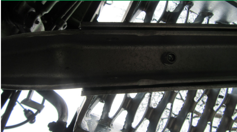
Auftritt wird mit 2 Senkkopfschrauben 8 x 30 u. Rondelle mit dem Tritthalter verschraubt
