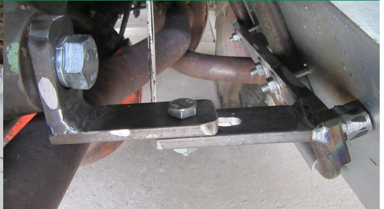
Auftritt mit 3 Schrauben 8 x 50 am Gegenhalter u. 1 Schraube 1 x 30 an der Verstrebung befestigt
