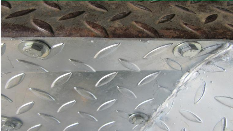
Auftritt wird am Trippbrett des Schleppers mit 2 Schrauben 8 x 25 befestigt
