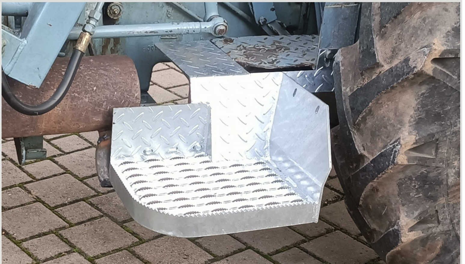
Anschraubstummel wird mit 5 Schrauben 8 x 20 und Beilagscheiben mit dem Auftritt verschraubt
