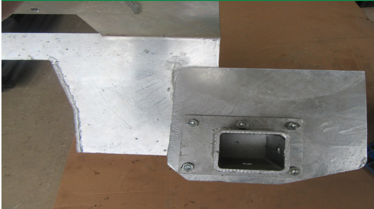
Anschraubstummel wird mit 5 Schrauben 8 x 20 und Beilagscheiben mit dem Auftritt verschraubt
