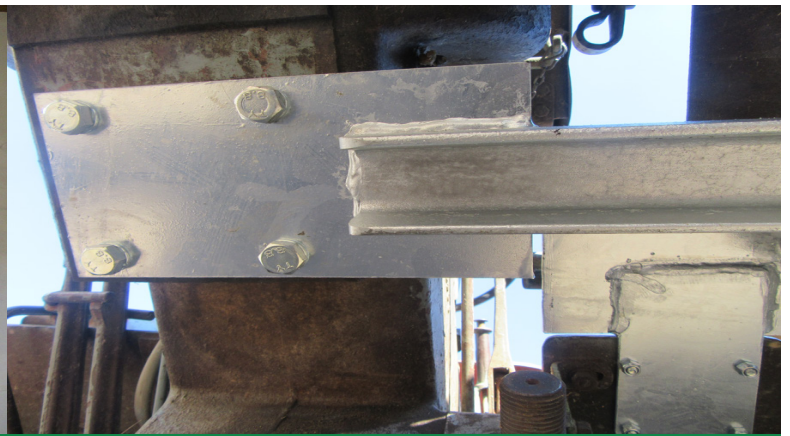
Tritthalter wird mit 4 Schrauben 12 x 25 mit Sprengung unten am Getriebeblock angeschraubt
