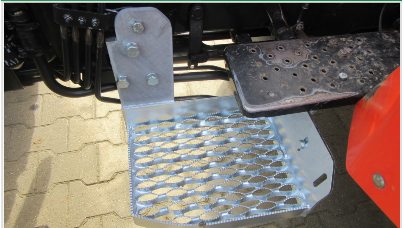
Gegenhalter wird mit 1 Schraube mit dem Trittbrett und 1 Schraube am Auftritt verschraubt
