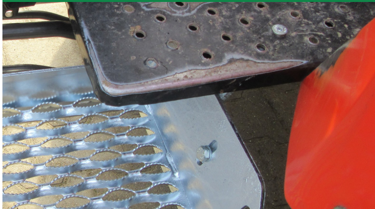
Gegenhalter wird mit 1 Schraube mit dem Trittbrett und 1 Schraube am Auftritt verschraubt
