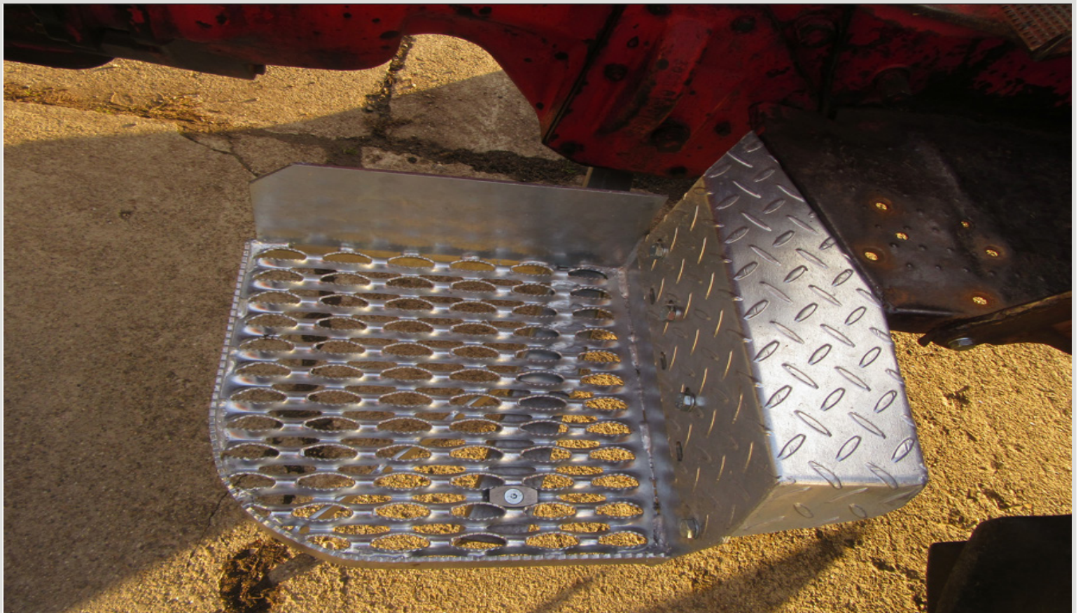
Auftritt wird mit 1 Schraube 12x50 u. Senkkopfschraube 8x35 mit Ausgleichsklammer, Rondelle u. Beilagscheibe mit dem Tritthalter verschraubt
