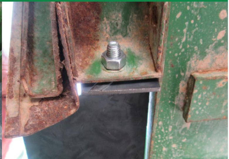
Ansicht von unten: Schutzblech des Auftritts wird mit Trittbrett verschraubt, Sechskantschraube 80x20
