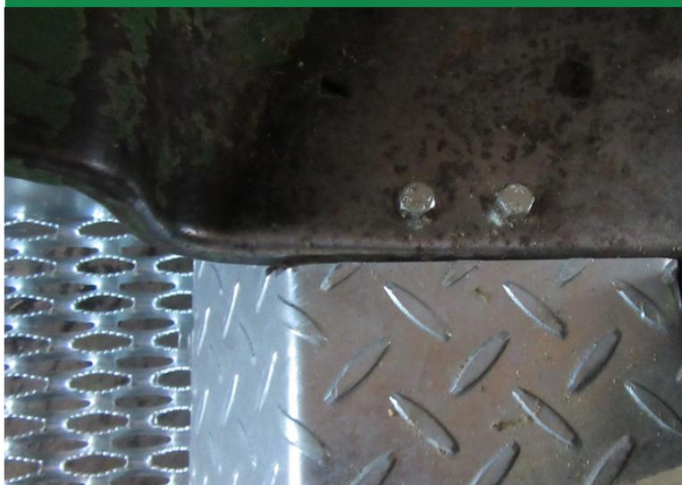
Schutzblech wird mit 2 Schr. 8x35 am Trittbrett verschr., 2x Bohrung 8,5mm am Trittbrett anbringen
