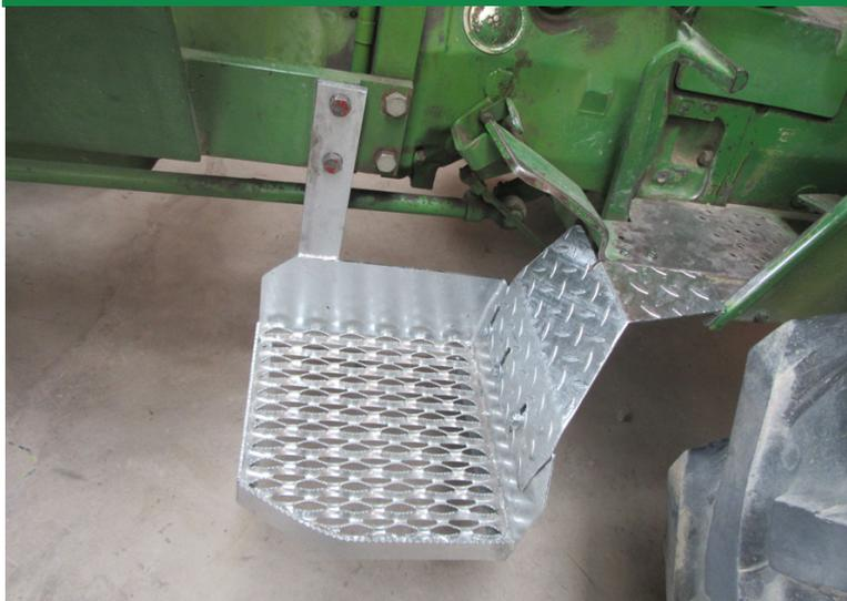
Tritthalter wird mit 2 Schrauben 1 ¼ Zoll mit Federring am Getriebekblock verschraubt
