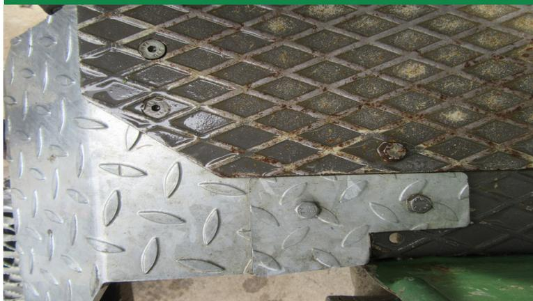
Schutzblech wird mit 2 bzw. 4 Schrauben 8x20 am Trittbrett angeschraubt
