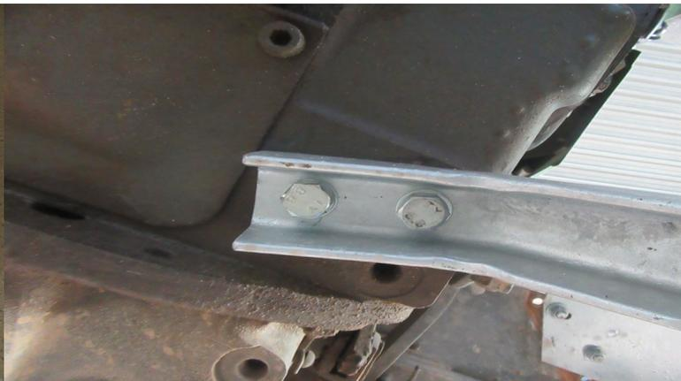
Tritthalter wird mit 2 Schrauben 12x25 mit Spreng-ring am Getriebelock befestigt
