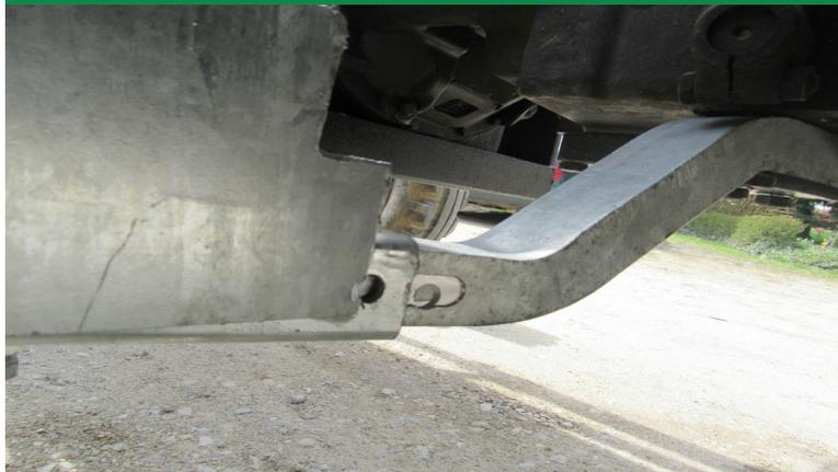
Auftritt wird mit Schraube 10x70 am Tritthalter befestigt
