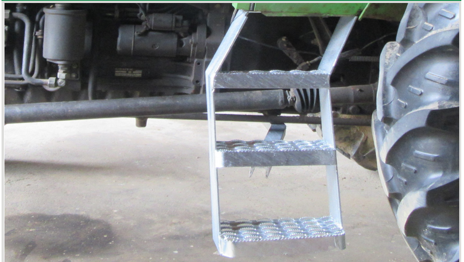
Trittleiter wird mit 2 Schrauben 12x25 mit dem Trittbrett verschweißt
