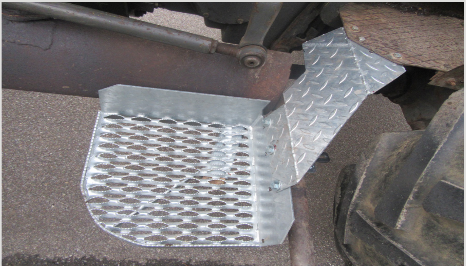
Schutzblech wird mit 3 Schrauben 8x20 am Trittbrett und mit 2 Schrauben 10x25 am Auftritt verschraubt
