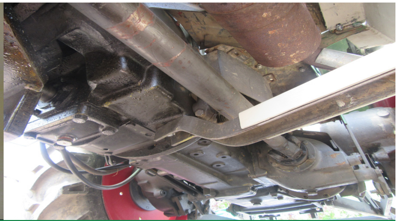
Tritthalter wird mit 2 Schrauben 12 x 25 und Sprengung am Getriebekblock verschraubt
