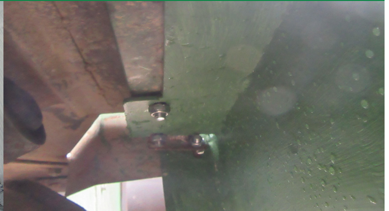
Winkelleiste wird mit 3 Schrauben 10 x 25 am Auftritt u. 2 Schloßschr. 8 x 60 unter der Kabine verschraubt
