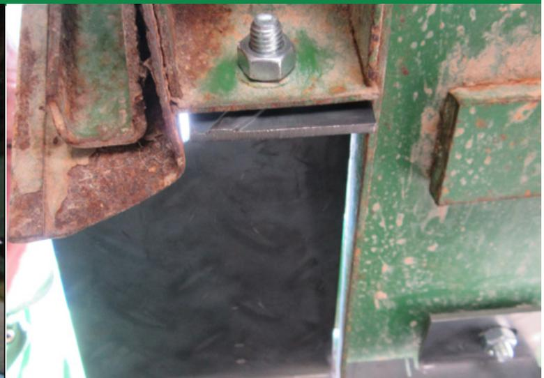
Ansicht von unten: Schutzblech des Auftritts wird mit Trittbrett verschraubt, Sechskantschraube 8x20
