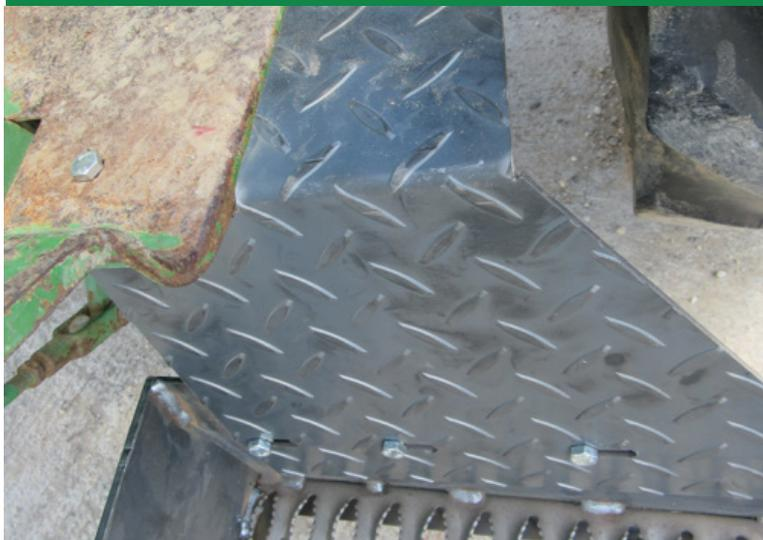
Schutzblech wird mit Schraube 8x20 mit dem Trittbrett verschraubt
