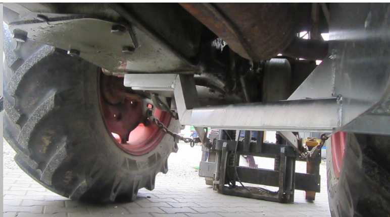
Tritthalter wird mit 2 Schrauben 14 x 25 u. 2 x Sprengring 14,5 am Getriebeblock befestigt
