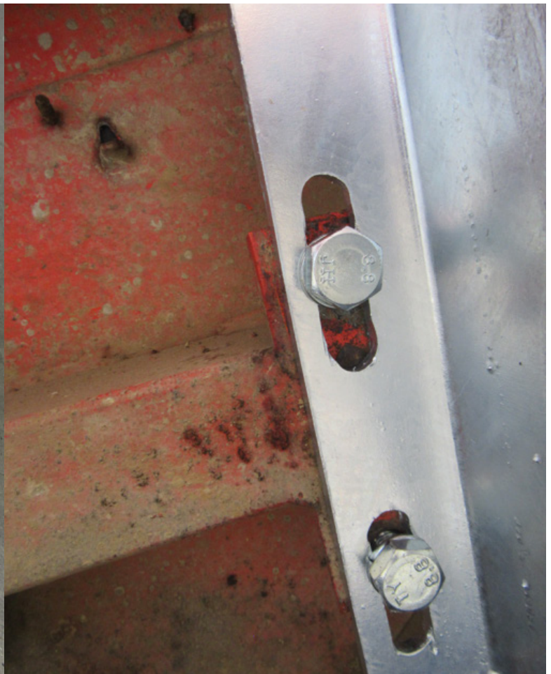
Trittleiter wird L u. R mit jeweils 2 Schrauben 12x30 mit Sprengring am Einstieg verschraubt
