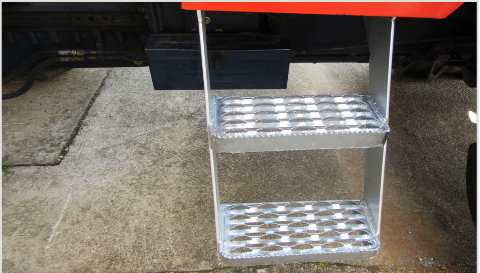
Lieferumfang: Trittleiter 2 sprossig, Sechskantschrauben 12x30 mit Sprengring 4x
