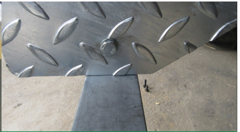
Schutzblech wird mit dem Tritthalter verschraubt
