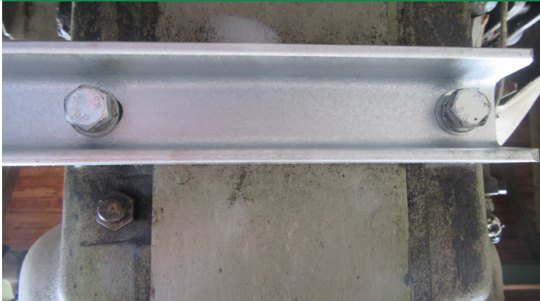
Tritthalter mit 2 Ausgleichsscheiben, 2 Schrauben 12x35 mit Sprengring 12,4 am Getriebeblock befestigt
