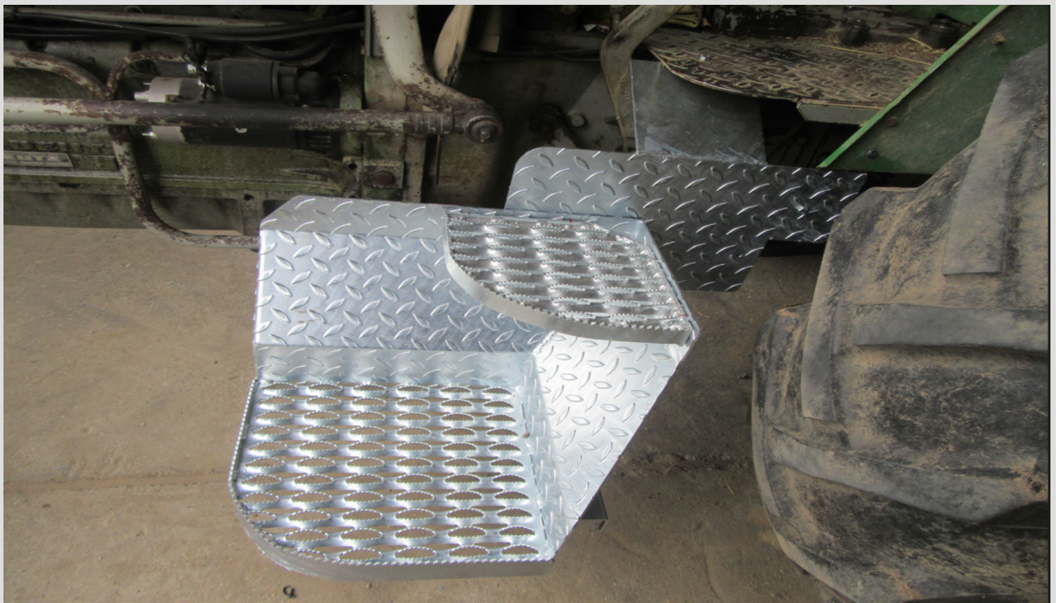
Tritthalter mit 2 Ausgleichsscheiben, 2 Schrauben 12x35 mit Sprengring 12,4 am Getriebeblock befestigt
