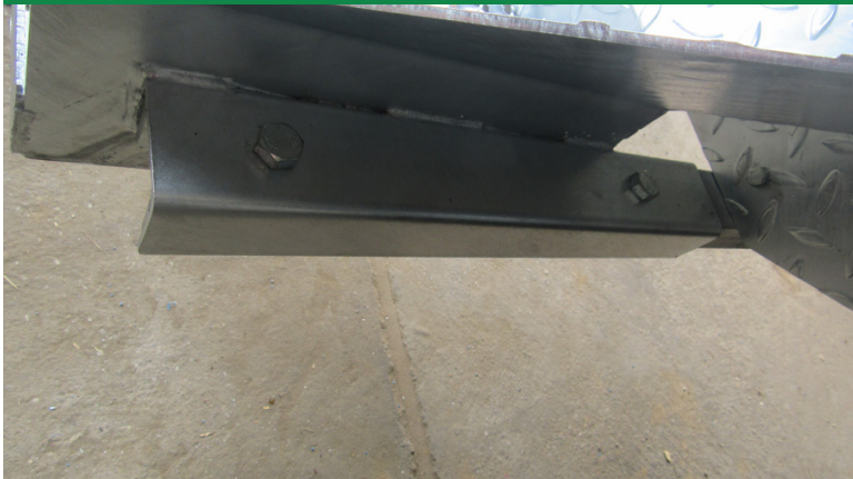
Auftritt wird am Tritthalter mit 2 Schrauben 12 x 25 verschraubt
