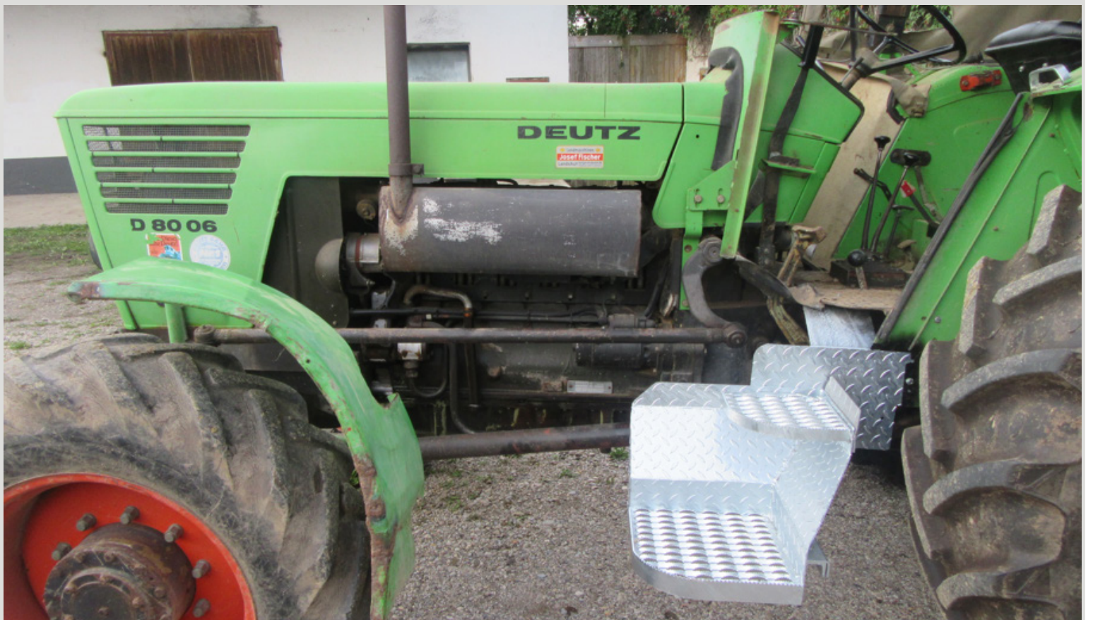
Auftritt wird am Tritthalter mit 2 Schrauben 12 x 25 verschraubt
