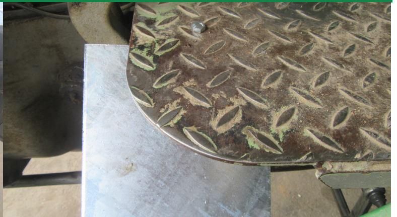
Bodenblech des Schleppers wird mit 1 Schraube 10 x 25 mit dem Schutzblech verschraubt
