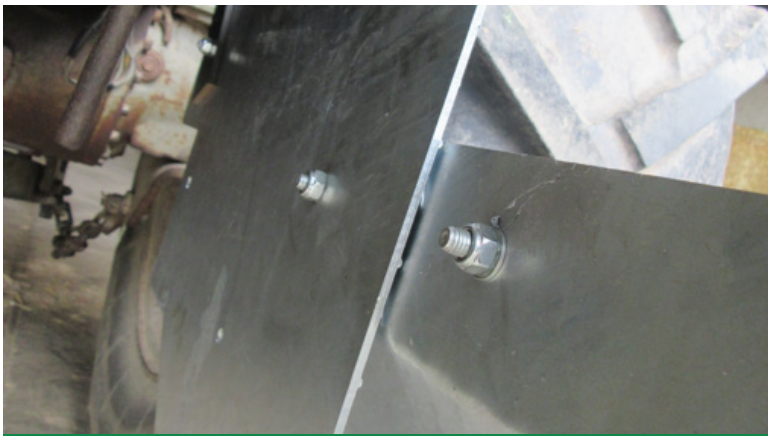
Am Schutzblech muss eine Bohrung 8,5 mm angebracht werden
