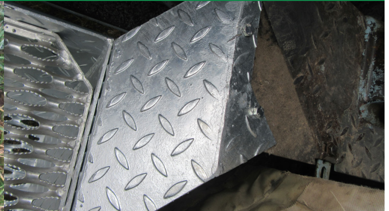
Schutzblech wird mit Trittblech des Schleppers verschraubt, Schrauben 8 x 20
