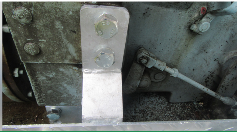
Konsole und Winkel werden mit Schlepper verschraubt: Schrauben 18 x 35 mit Sprengling 6x
