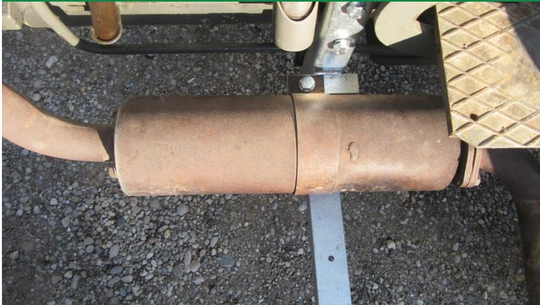
Auspufftopf wird mit Tritthalter verschraubt mit Schraube 10 x 25
