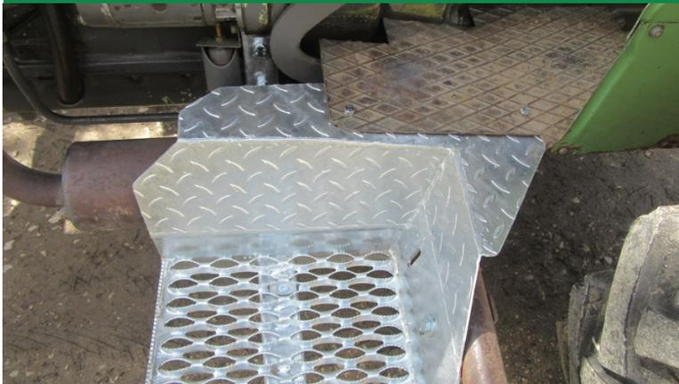
Auftritt wird mit Schraube 8 x 25 u. Schraube 8 x 30 mit dem Trittbrett verschraubt
