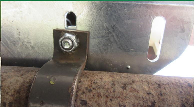
Auspuffschelle wird mit Auftritt verschraubt, Schraube 12 x 30
