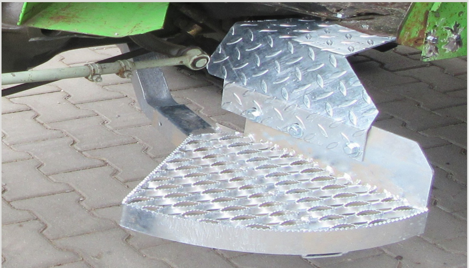
Schutzblech mit 2 Schrauben 10x25 mit dem Auftritt verschraubt - bei Auspuff nach oben 3 Schrauben
