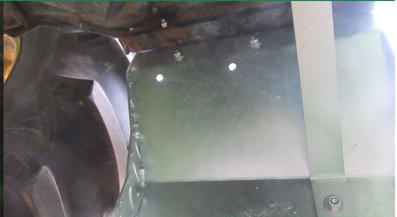
Gegenhalter wird mit Schraube 8 x 25 am Auftritt verschraubt
