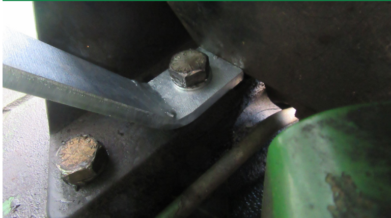
Gegenhalter wird mit Schraube \frac{5}{8} x 2 Zoll und Sprengring 16,5 am Getriebelock befestigt
