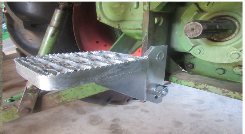
Auftritt wird mit einer Sechskantschraube 20x45 mit Federring und Sechskantmutter M20 unter dem Zugmaul an der Führungsschiene montiert
